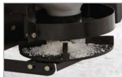
La sonde en polyvinyle de 25 cm permet une répartition uniforme du matériau dégivrant.
